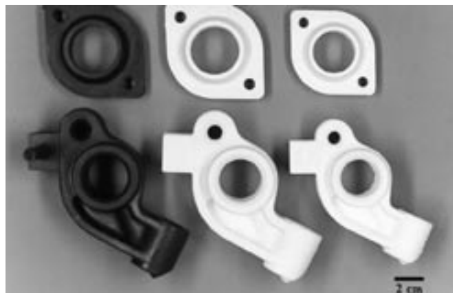
Figura 2. Ejemplo de probetas fabricadas por inyección: Cojinetes y válvulas en verde, después de la oxidación y después del sinterizado 20 .
